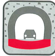
トンネル (インバート設置)
