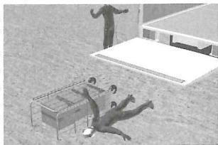
状況…テールゲートリフターの付いているトラックから、ロールボックスパレットを降ろしていた。パレットをテールゲートまで運び、手で押さえたまま落下した。
