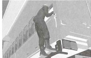
状況…ウィングルーフトラックで出発直後、積荷のバランスが気になり構内に停車した。ウィングを開きステップに足を掛け荷台の中を覗き込もうとしたとき、ステップの奥にあるウィングのボタンに足が触れ、ウィングが作動。ウィングと車体の間に胴体が挟まれ、重傷を負った。
