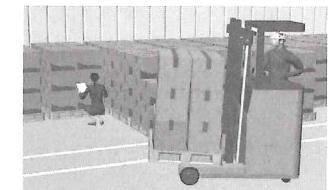
状況…完成した製品を倉庫に収納するため、リーチフォークリフトで搬送していた。普段は倉庫に入らないはずの事務員が、急ぎの在庫チェックで倉庫に入っていた。運転手は事務員がいることに気づかず、荷を降ろそうとして、荷の間に挟んでしまった。
