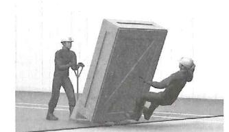
状況…工場内で大型機器の入れ替えのため、ハンドリフトを用いて2人で構内を搬送中、通路のつなぎ目の段差でバランスを崩し荷が転倒、前方で押されていた作業員が下敷きになった。
