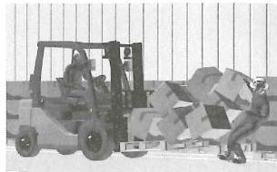
状況…フォークリフトで搬送中、運転手は前方に歩行者がいることに気がついたが、そのまま減速せずに通り抜けようとした。突然、歩行者がフォークリフトの走行路に飛び出したので、運転手はあわてて急ブレーキをかけた。衝突は免れたが、荷が前方に崩れ、歩行者に激突した。
