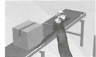
状況…機械部品の製造工場で、箱詰めされた完成品をベルトコンベヤーで搬送中。作業員がベルトコンベヤー上の荷のズレに気付き、修正しようと腕を伸ばしました。その際、左手がガイドローラーに巻き込まれて負傷した。
