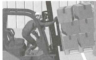
状況…トラックで運送するために、倉庫に積まれていた荷をフォークリフトで降ろしていた。途中で荷が崩れそうになったので、あわてて停止し、荷を整頓するため運転席から身を乗り出した。その時、身体の一部が操作レバーに引っかかり、マストが後傾し身体が挟まってしまった。
